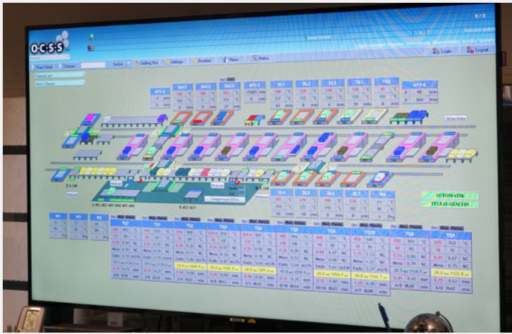
Bild 3: Moderne Messwarte mit Visualisierung des gesamten Härterei-betriebes
