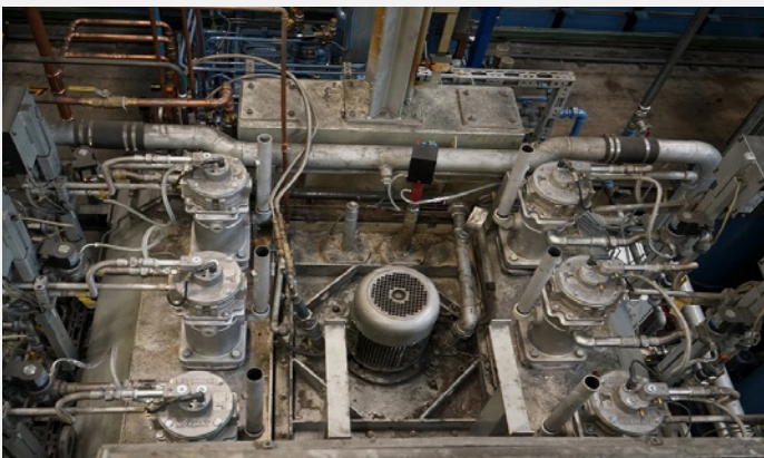
Bild 4: Blick auf zwei Kammeröfen nach dem Retrofit – links lediglich Austausch der Basisbrenner; rechts Austausch der Brenner inkl. Gas- und Luftzuführung sowie Brennersteuerung
